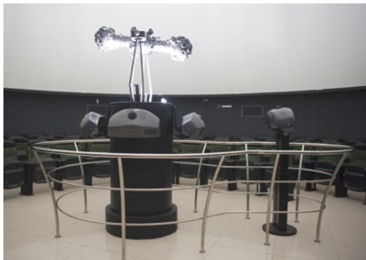
Projetor Astronômico de 14 mil fibras ópticas que permite apresentações com altíssimograu de precisão
