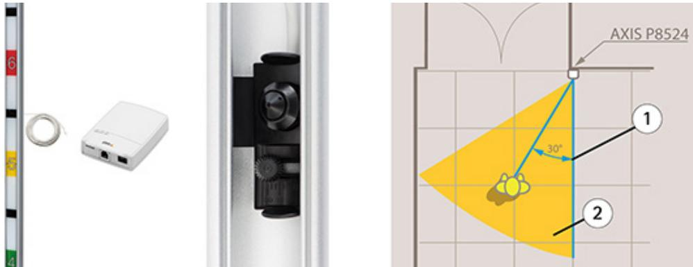
Desenho de uma instalação de AXIS P8524 em uma porta onde o sensor está deslocado de 30°
